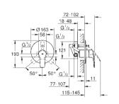
Eurosmart Monomando para baño y ducha 1/2" Empotrable Palanca metálica GROHE SilkMove Cartucho de discos cerámicos 46 mm
