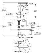
Monomando de lavabo de 1/2" Tamaño L Palanca metálica GROHE SilkMove Cartucho de discos cerámicos 28 mm Limitador ecológico de temperatura GROHE Long-Life acabado duradero Tecnología GROHE Water Saving ahorro de agua con el máximo bienestar Caudal máximo a 3 bar: 5 l/min Mousseur SpeedClean GROHE AquaGuide mousseur ajustable
