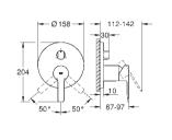
discos cerámicos 46 mm GROHE Long-Life acabado duradero Florón metálico con GROHE FastFixation Escudo de metal, con ajuste 6° Palanca metálica Inversor de 3 vías.
