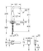
Mezclador de lavabo electrónico 1/2" Tamaño M con mezclador y limitador ajustable de temperatura Con sensor infrarrojo para comunicación bidireccional
